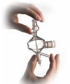
Многофункциональная система ввода проб (MSIS) позволяет определять мышьяк, селен и ртуть в концентрациях ниже миллиардных долей (ppb).
