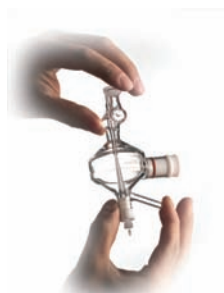
Multimode Sample Introduction System (MSIS) zur Bestimmung von As, Hg und Se im Sub-ppb-Bereich
