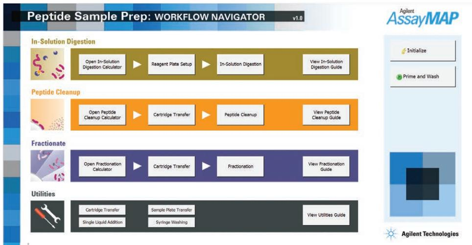
简单的软件界面提供一键式控制，指导您完成消解、纯化和分离工作流程。
