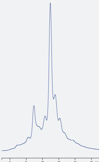
IgG 单克隆抗体分析使用 Agilent Bio MAb 5  $\mu$ m, 4.6 x 50 mm 色谱柱，采用了 6.5 到 7.5 (0-20 min, 50 mM) 的 pH 梯度
