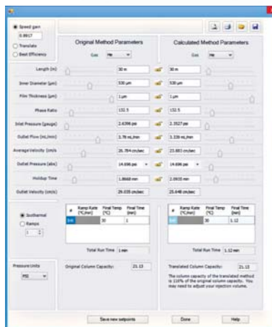
Mit der Method-Calculator-Funktion lassen sich problemlos Methoden zur Reduzierung der Analysezeiten oder für den leichten Wechsel des Trägergases einrichten.
