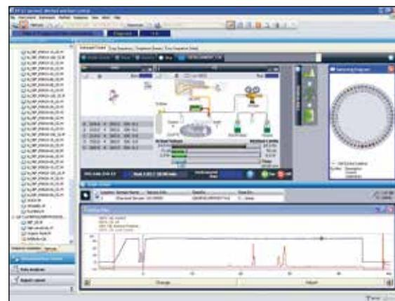
标准的 7100 毛细管电泳系统仪器控制和数据分析软件可以扩展到对 Agilent 6000 系列单四极杆质谱系统进行控制
