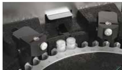
带样品瓶感应器和入口/出口升降装置的自动进样器转盘
