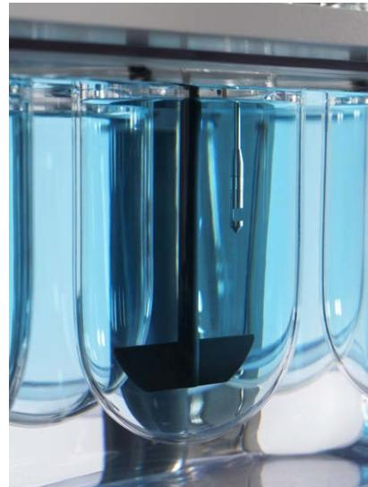
探头采用石英光纤，以确保最佳的性能。可互换的顶部探针具有从 1 mm 到 20 mm 不等的光程选择，可按需更换而无需购买新的探头
