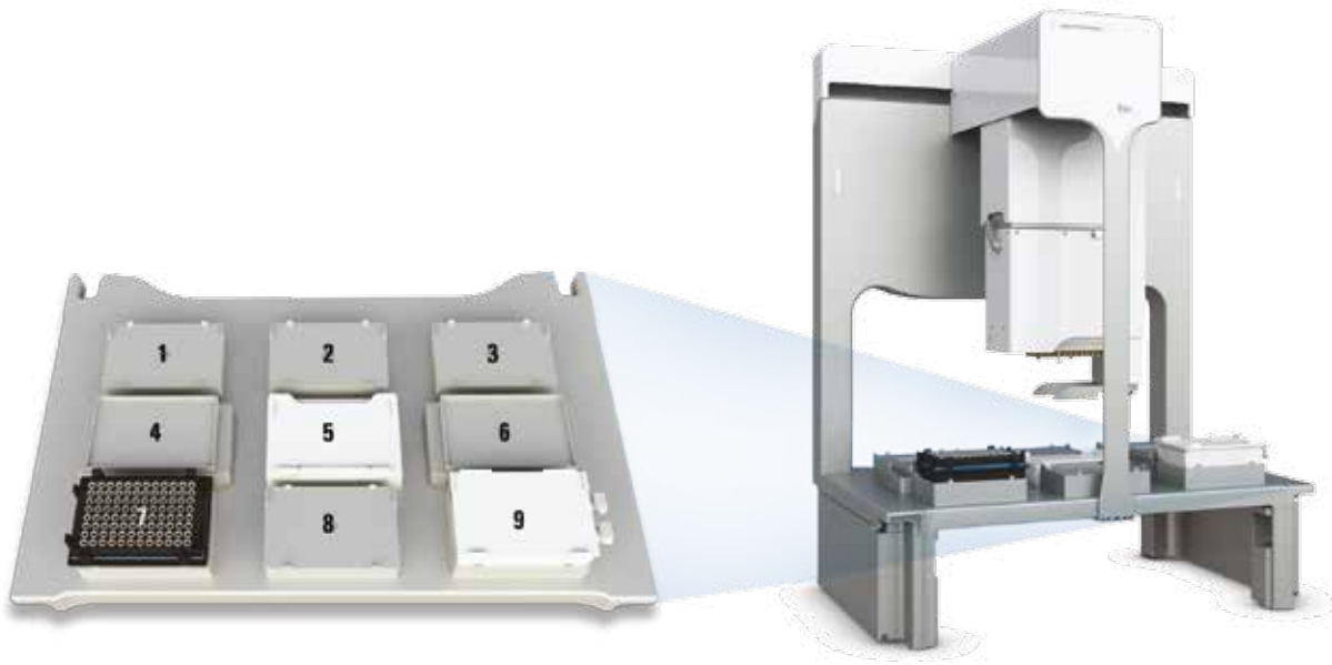
그림 15. Agilent Bravo 자동 Liquid Handling 플랫폼 및 CYP450 에세이용 데크 레이아웃과 Orbital Shaking Station (위치 8). 프로토콜을 시작하기 전, 5개의 microplate(위치 7) 스택과 3개 저장소(위치 1~3) 및 3개 tip box(위치 4~6)를 수동으로 데크에 배치합니다. (Agilent 발행물 5990-3550EN을 참조하십시오.)
