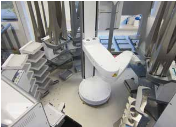
그림 16. 맞춤형 BioCel 자동화 솔루션 - Bravo 플랫폼, PlateLoc Sealer, Hotel, LabWare Stacker 및 DDR 로봇으로 구성
