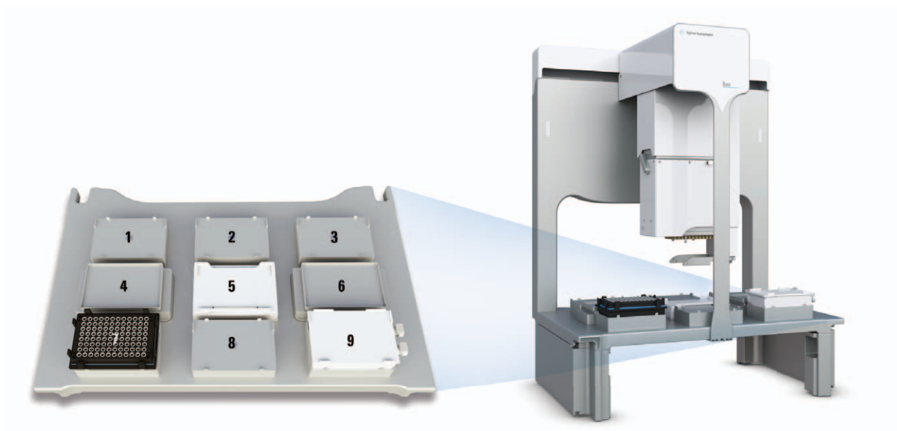
图 15. 安捷伦 Bravo 液体处理平台和 Bravo 台板布局，用于 CYP450 分析，包括一个回旋式振荡板位（位置 8）。方法开始运行前，手动安放一摞 5 个微孔板（位置 7）、三种试剂（位置 1-3）和三个枪头盒（位置 4-6）。（参见安捷伦应用简报 5990-3550EN）
