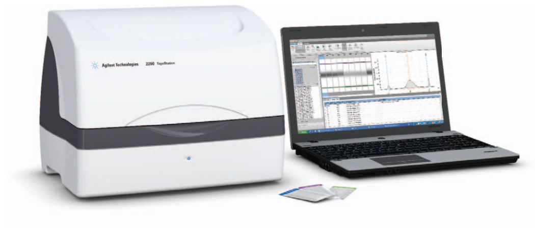
2200 TapeStation 系统使用信用卡大小的一次性安捷伦 ScreenTape 用于 DNA、RNA 和蛋白质的分析。将 ScreenTape 插入到 2200 TapeStation 中，加载针头，从 16 位试管或者 96 孔板取样，一分钟分析一个样品
