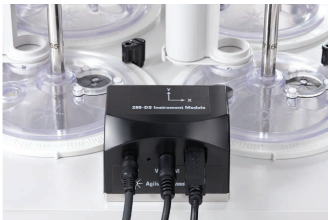
280-DS 仪器模块安装于溶出杯板上, 用于测量板的水平度 (X 和 Y 轴) 与振动 (X、Y 和 Z 轴)
