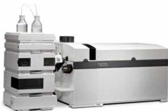
8800 ICP-MS/MS 与 1200 系列液相色谱系统联用
