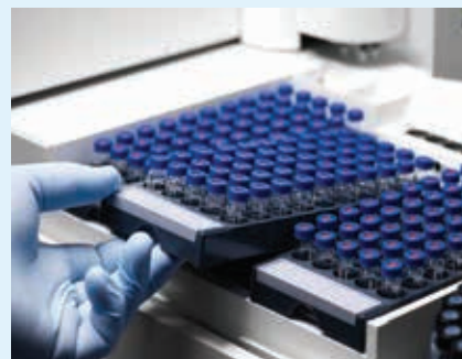
Plateau de flacons de l'injecteur automatique d'échantillons liquides Agilent série 7693A.
