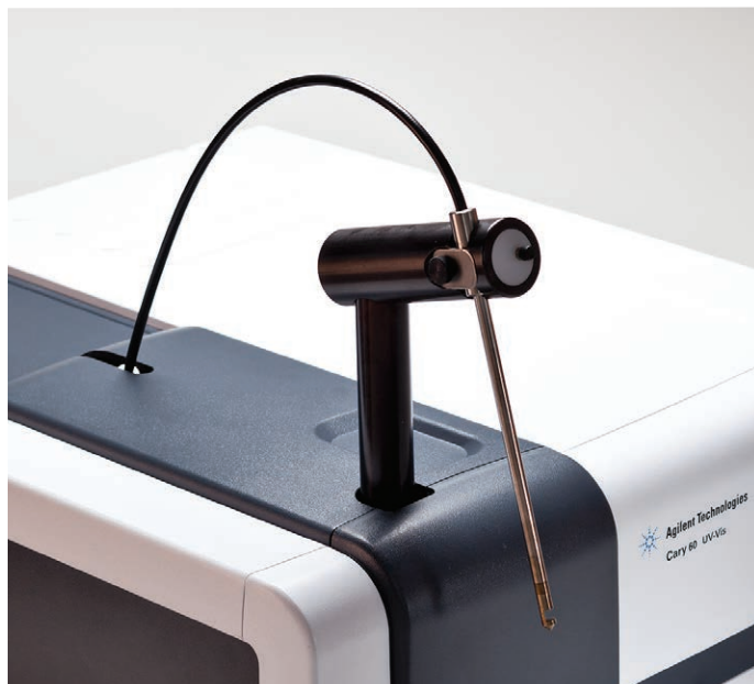
避免比色皿和蠕动泵带来的麻烦 使用光纤探头，您再也无需购买或清洗比色皿。
