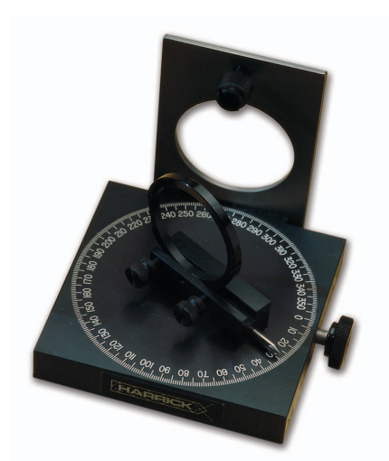
Brewster 角支架測量固態樣品在不同入射角下光的透射率
