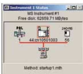
质谱工作站为 GC、AS 和 MS 提供完整的自动化控制
