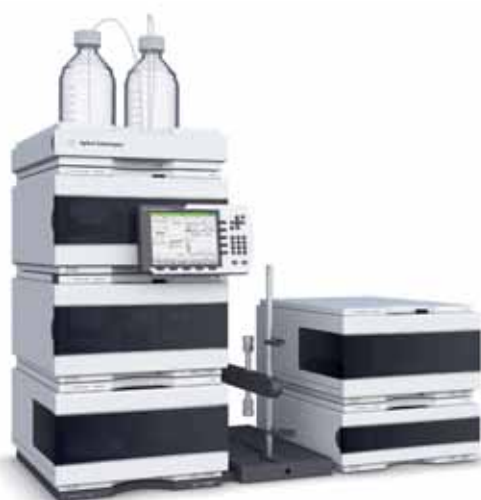
УФ-система препаративной очистки для сбора фракций в количестве от миллиграммов до граммов.
