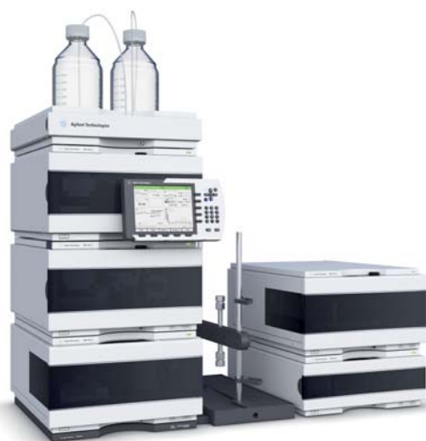
Sistema de purificação de escala preparativa baseado em UV para capturação de quantidades de miligramas até gramas.
