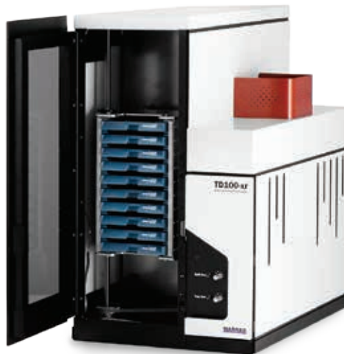
Les 10 plateaux du TD100-xr pouvant chacun accueillir jusqu'à 10 tubes bouchés et incorporant l'option « 50:50 » pour la récupération automatique des échantillons
