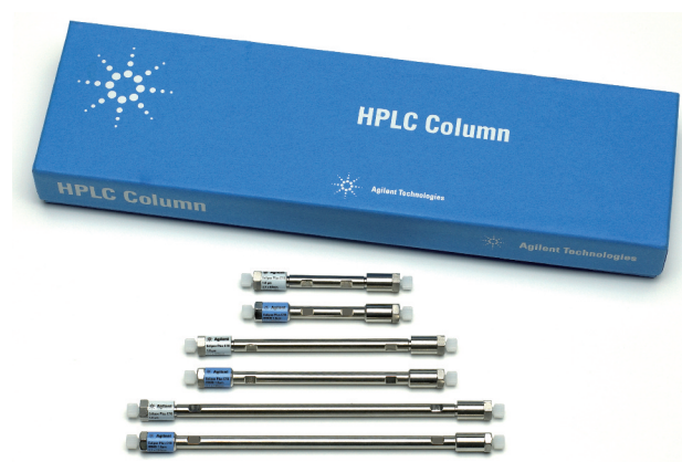
As colunas ZORBAX RRHD estão disponíveis com diâmetro interno de 2,1 e de 3 mm e com 50, 100 e 150 mm de comprimento.
