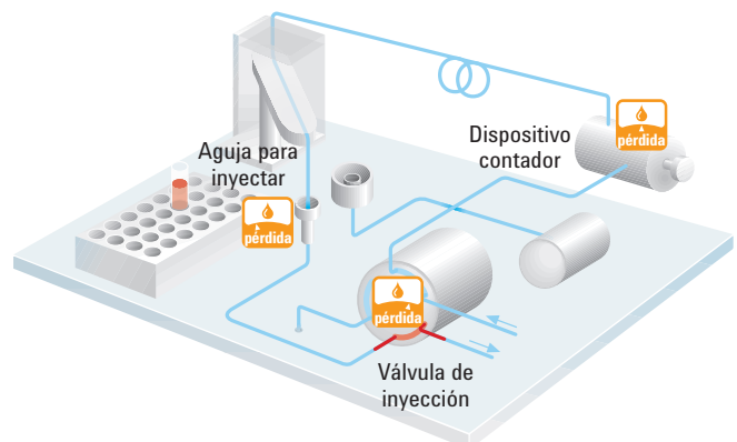
Calculando los índices de pérdida de la válvula de inyección, del dispositivo de medición y del asiento de la aguja, se puede determinar el fallo fácilmente.
