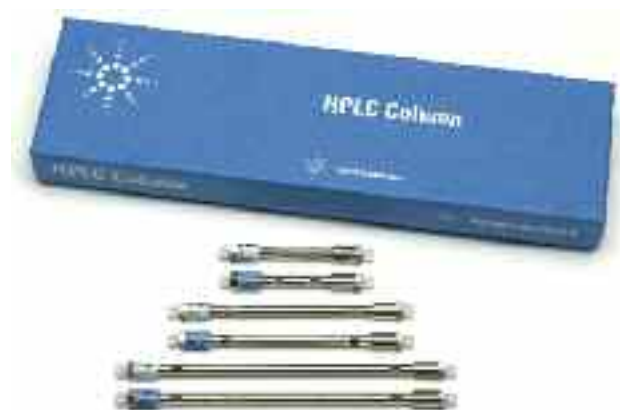
ZORBAX RRHD 色谱柱有 2.1 和 3 mm 内径，50、100 和 150 mm 柱长可供选择
