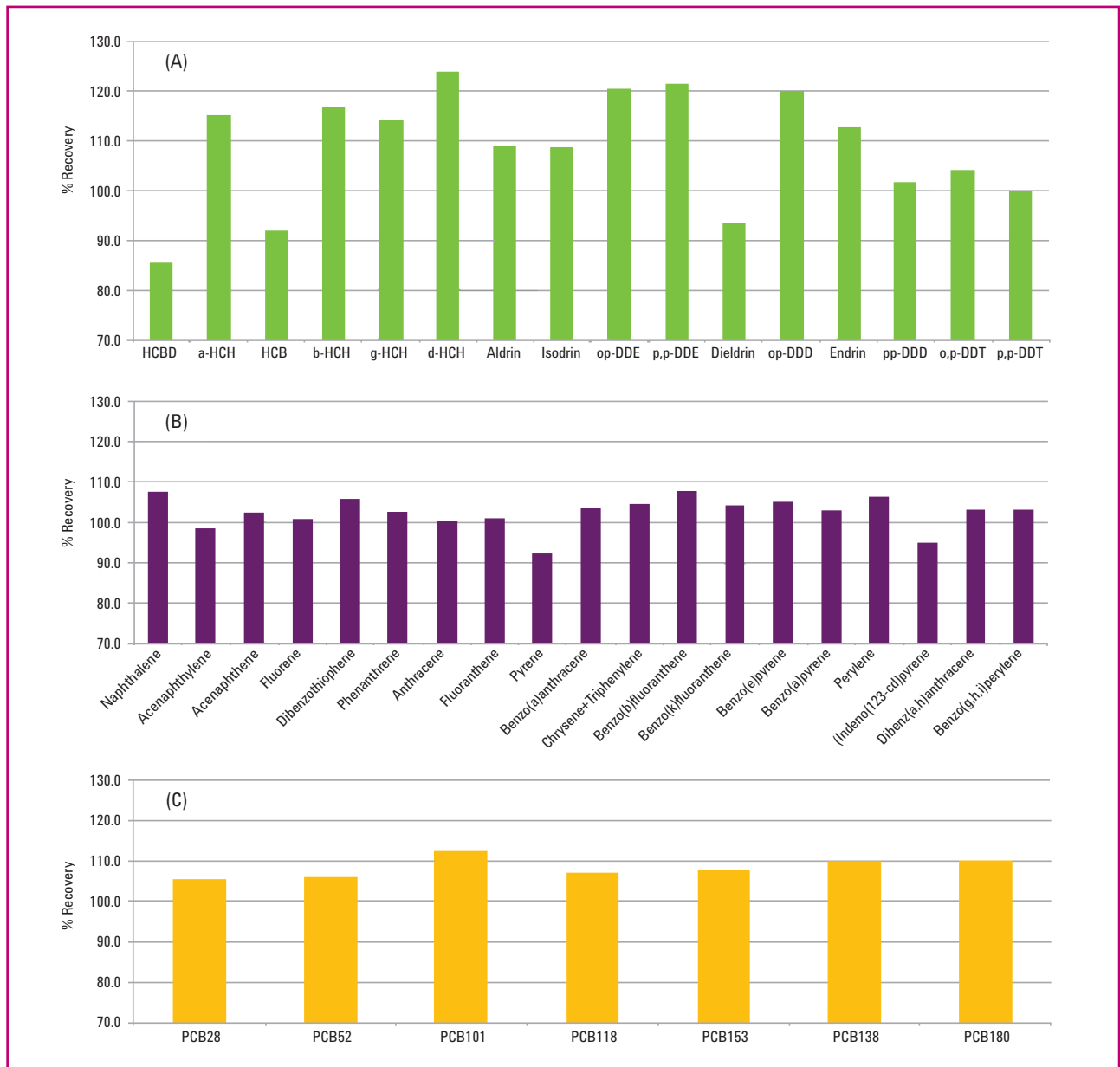
그림 3. 스파이킹된 혼합 조직 내 (a) OCP, (b) PAH, (c) PCB 분석물 회수율에 대한 시각화 결과
