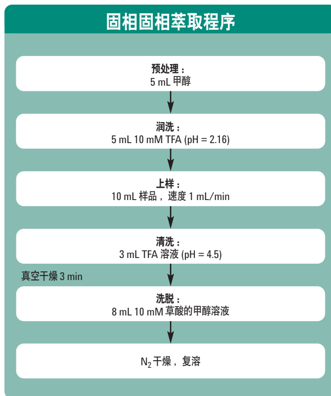
图 1. 四环素固相萃取程序
