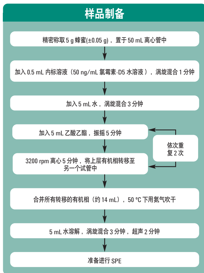
图1. 样品制备 – 蜂蜜中氯霉素类化合物的液/液萃取
