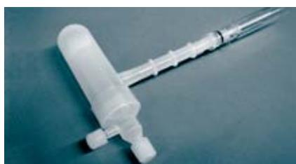
**全惰性进样系统：**由污染最小的 PFA 材质制成，无 O 圈设计。该系统还包括可拆卸式炬管、铂金或蓝宝石中心管。可耐受浓氢氟酸，极适合于高纯试剂的分析。
