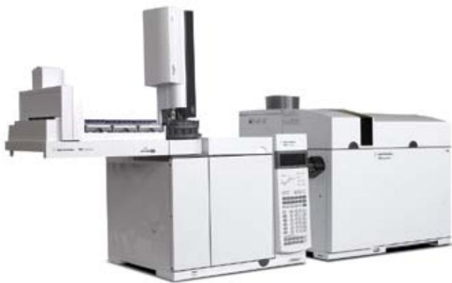
7890A GC — 7700 ICP-MS 联机系统
