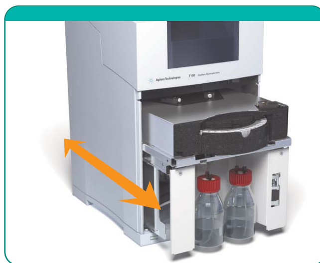
El CE 7100 ofrece un acceso rápido y sencillo a los electrodos, los perforadores, la electrónica y los tubos.
