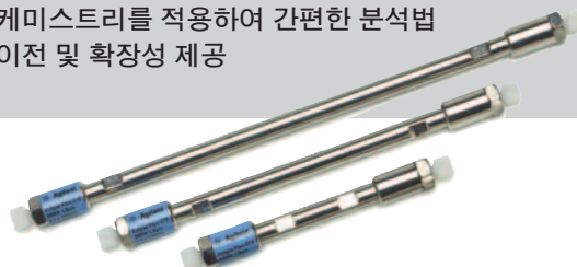
ZORBAX RRHD 컬럼은 2.1 및 3 mm의 내부 직경 및 50, 100, 150 mm의 길이로 공급됩니다.
