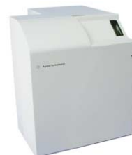
Чип-ВЭЖХ / МС с электростатическим распылением нанопотоков (нл/мин). Полностью законченное хроматографическое решение по подготовке и разделению проб, размещенное в полимерной пластине (чипе). Для подключения к масс-детекторам на основе ионной ловушки.
