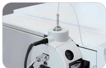
Sorgente per fotoionizzazione a pressione atmosferica (APPI)
