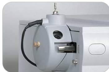
Sorgente per ionizzazione chimica a pressione atmosferica (APCI)
