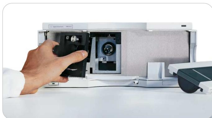
Acceso frontal, con alineación automática, a componentes susceptibles de recambio como la lámpara y las celdas de flujo.
