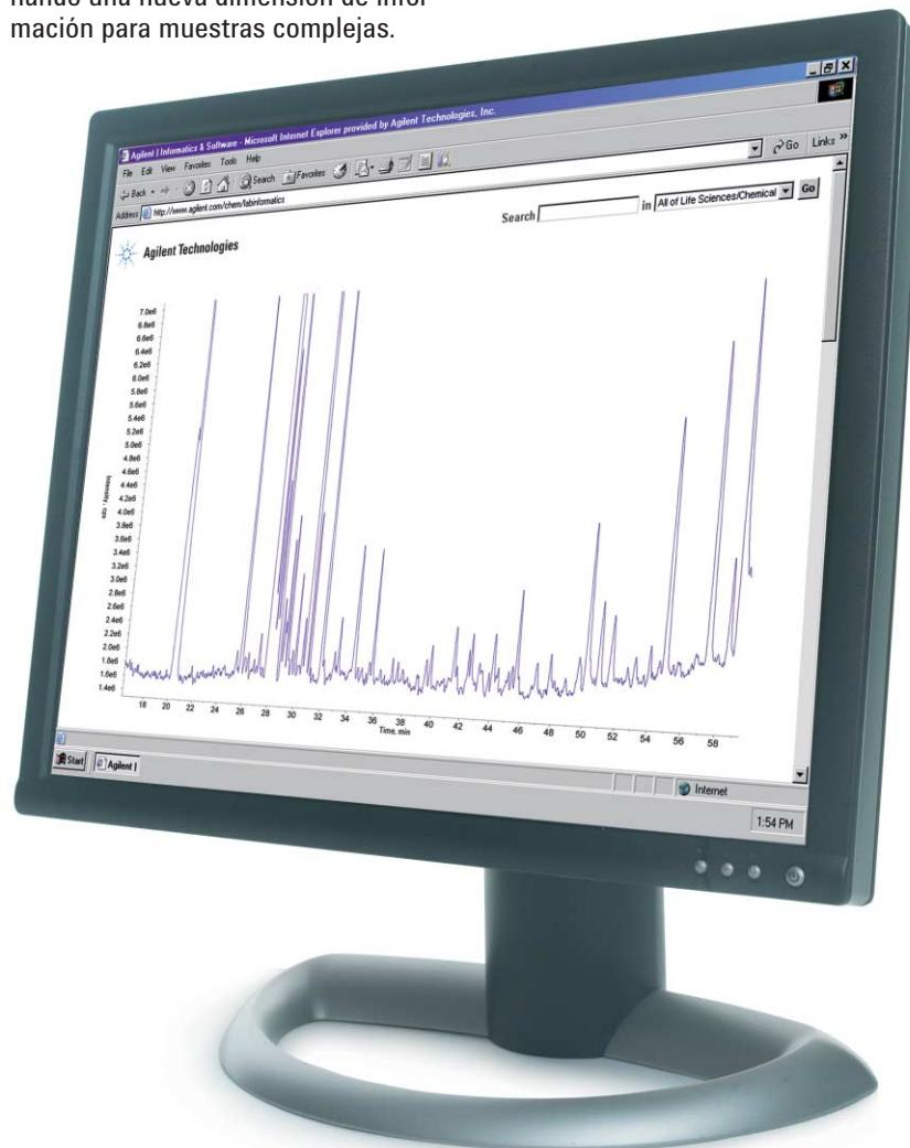
Cromatografía de alta resolución de un extracto de raíz de ginseng con el sistema Agilent Serie 1200 de resolución rápida y detección TOF, con anchura de pico promedio de 0,13 minutos y una capacidad de 540 picos.
