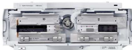
Enfriamiento/calentamiento Peltier desde 10°C por debajo de la temperatura ambiente hasta 100°C.
