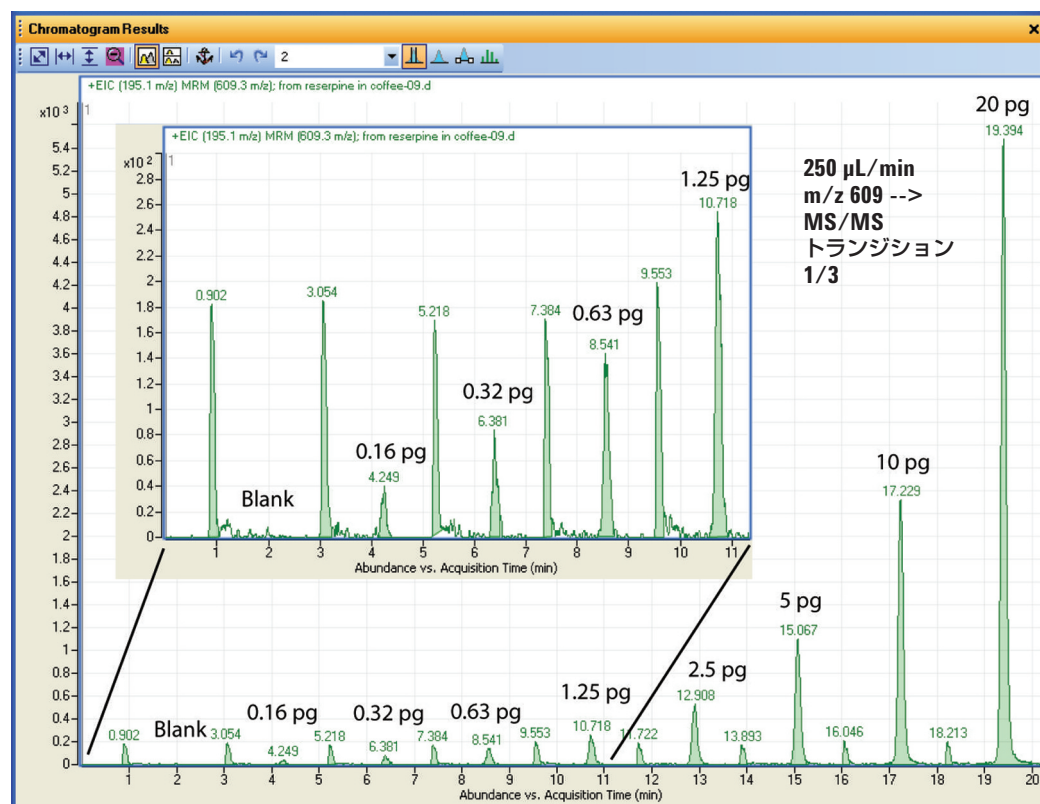
コーヒー中レセルピン希釈液の一斉分析において、複雑なマトリックスでもフェムトグラム単位の感度が得られます。
