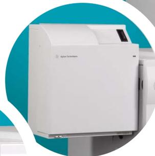
L'interfaccia HPLC-Chip Cube ottimizza la sensibilità quando si lavora a nanoflussi
