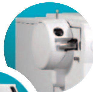
双喷雾器电喷雾离子源可以方便地获得精确质量数
