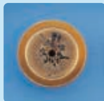
汚れた、あるいは腐食した 金メッキ注入シール
