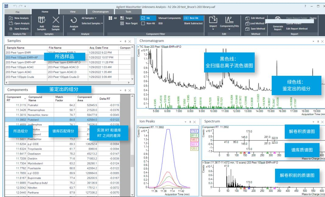
简单直观：Agilent MassHunter 未知物分析软件提供自动解卷积和谱库搜索功能，以鉴定目标化合物。
