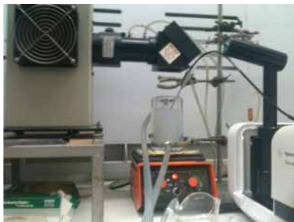
図 1. 光ファイバマイクロプローブアクセサリを設置した Cary 60 UV-Vis を使えば、サンプルの in situ 測定や装置から離れたサンプルの測定が容易になります。
