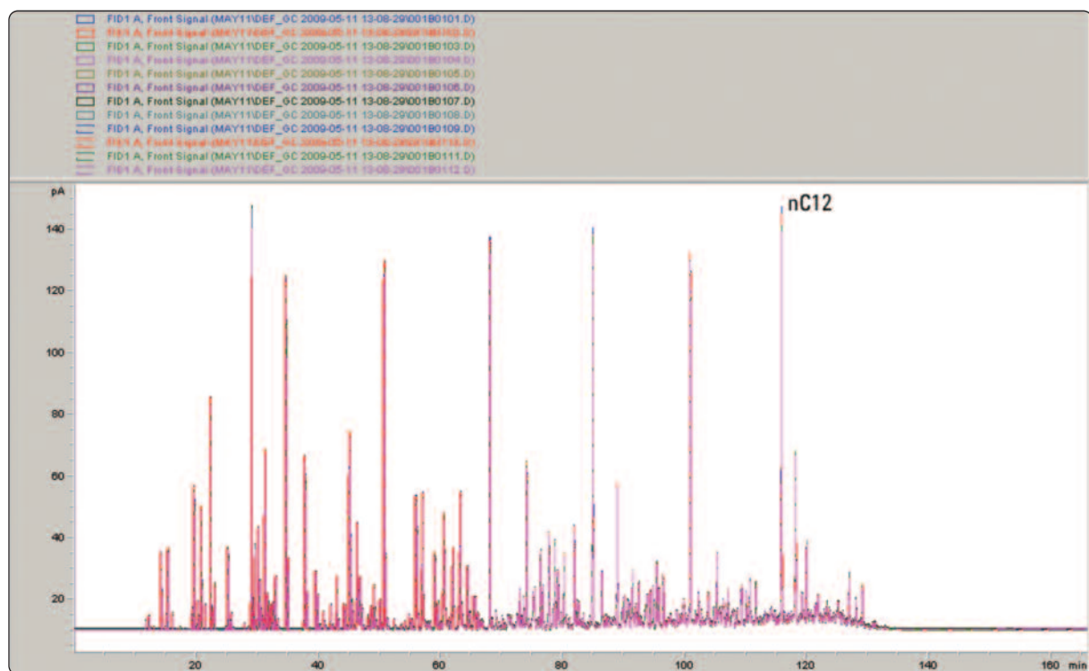
図 9. C12 と C13 の間でバックフラッシュされた原油の 12 回の分析の重ね書き
