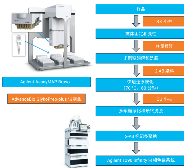
图 1. 多聚糖分离、标记、纯化并随后使用安捷伦解决方案进行液相色谱分析的工作流程示意图。Agilent AssayMAP 步骤显示为蓝色; AdvanceBio 试剂盒显示为橙色
