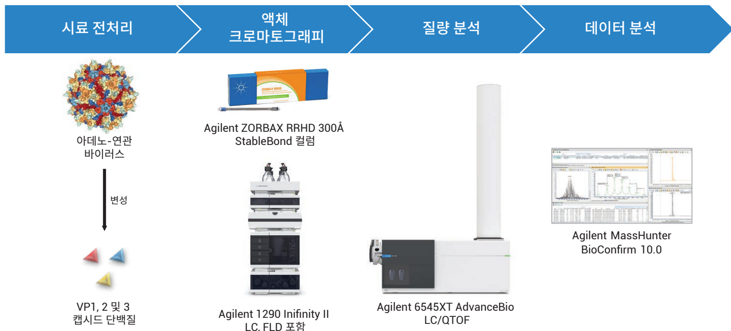
그림 1. 이 응용 자료에서 사용된 장비 및 소모품.
