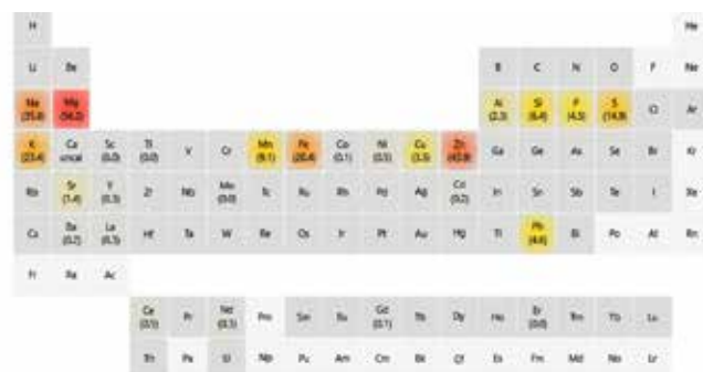
Figura 2. La mappa di calore IntelliQuant mostra le concentrazioni relative di tutti gli elementi presenti in un campione.
