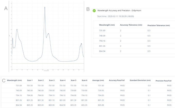
图 5. 钕谱滤光片的波长准确度测试结果。(A) 钕谱的六次波长扫描结果；(B) 峰位置和误差；(C) 每次扫描的原始峰位置与平均值、标准偏差以及合格/不合格结果制成的表格
