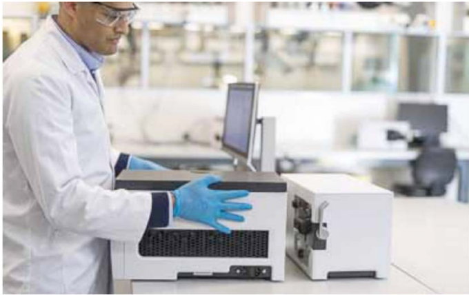
그림 1. Cary 3500 Multicell 분광 광도계는 엔진(그림 오른쪽)과 멀티셀 모듈(그림 왼쪽)로 구성됩니다. 이 두 가지 부품을 연결해 완전한 분광 광도계를 만들 수 있습니다.
