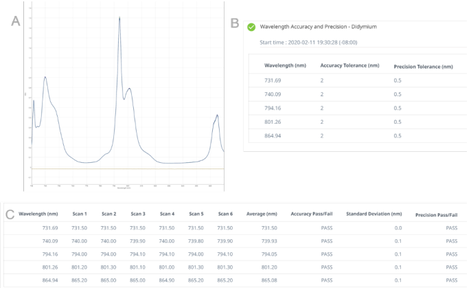
그림 5. Didymium 필터에 대한 파장 정확도 테스트 결과. (A) didymium의 6회 파장 스캔, (B) 피크 위치 및 허용오차, (C) 각 개별 스캔에 대한 원래 피크 위치와 표로 작성한 평균, 표준편차 및 합격/불합격 결과
