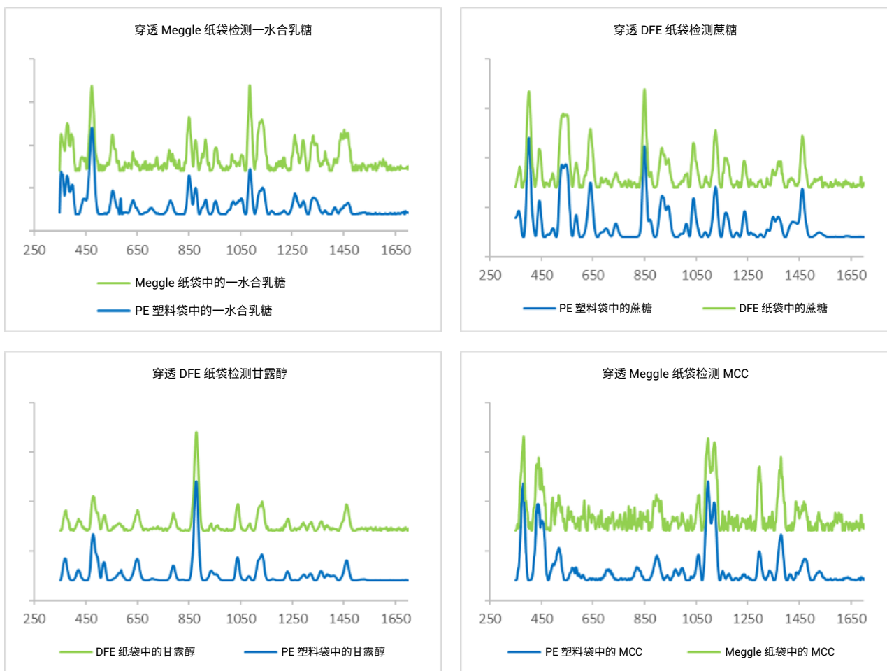
图 2. 穿透 DEF 纸袋的蔗糖和甘露醇, 以及穿透 Meggle 纸袋的 MCC 和一水合乳糖采集的光谱。与穿透聚乙烯塑料袋采集的蔗糖、甘露醇、MCC 和一水合乳糖拉曼光谱重叠的 SORS 光谱
