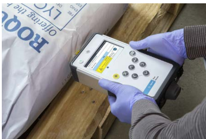
图 1. 使用 Vaya 拉曼光谱仪器穿透多层纸袋鉴定内容物
