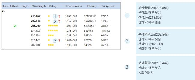
그림 1. IntelliQuant 별표 등급 시스템은 데이터 분석을 통해 동일한 원소에 여러 방출 파장 등급을 지정합니다. "?" 기호를 클릭하면 파장 등급이 낮은 이유가 표시됩니다.
