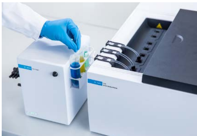
图 1. 连接至 Cary 3500 多池紫外-可见分光光度计的 Cary Sipper 蠕动泵附件
