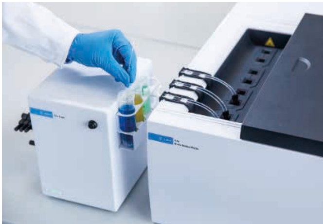
図 1. Cary 3500 マルチセル UV-Vis 分光光度計に接続された Cary シッパーアクセサリ
