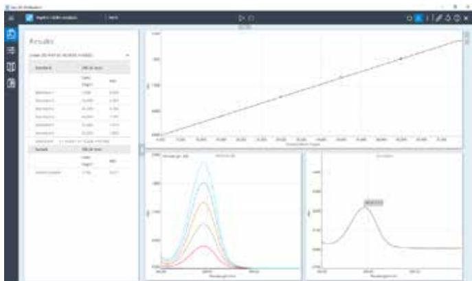
Рис. 4. ПО APM Cary UV с калибровочной кривой салициловой кислоты (вверху в центре) и соответствующие спектры стандартов (внизу в центре) и таблетки (внизу справа). Слева приведены линейное уравнение и коэффициент корреляции, а также исходные значения оптической плотности при 296 нм
