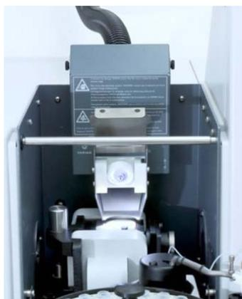
图 1. 用于 Agilent GTA 120 石墨管原子化器的可选的安捷伦排烟/LED 附件
