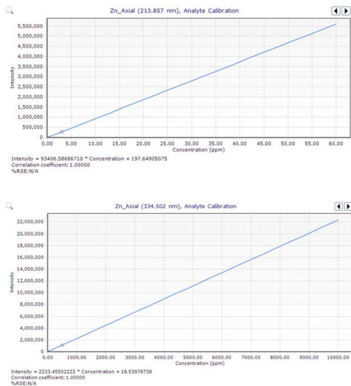
图 1. 在本例中, MultiCal 使用 Zn 213.857 nm (轴向观测) 测量浓度高达 60 mg/L (上图) 的分析物, 并使用 334.502 nm (轴向观测) 谱线测量更高浓度的分析物, 线性范围上限达 10000 mg/L (下图)
