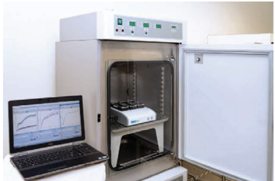
Figura 6. Análisis celular en tiempo real directamente dentro de una incubadora. Colocados en el interior de una incubadora estándar de cultivos de tejido o una cámara de hipoxia, los instrumentos Agilent xCELLigence son compatibles con todo el rango biológicamente relevante de temperaturas, composiciones ambientales y humedades.
